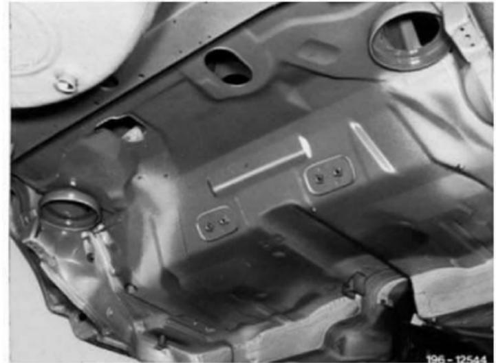
**Anm.:** Nach Reparaturarbeiten (Instandsetzen und Erneuern des Hinterkotflügels) ist im Streubereich der Hinterräder an der Außenhaut MB-DAUER-UNTERBODENSCHUTZ Teil-Nr. 001 986 01 10, dem 5 % Wasser zugesetzt ist, auf Verlaufs zu spritzen und in Wagenfarbe zu lackieren.
