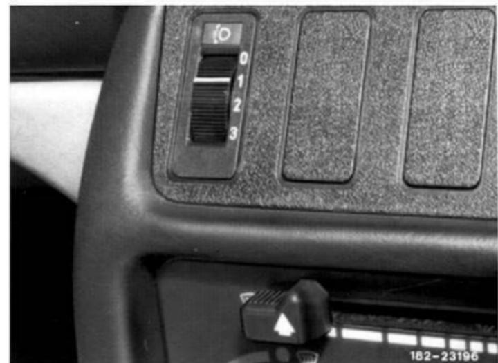
Fahrzeuge mit Diesel-Motoren haben eine Unterdruckpumpe. Der Unterdruck wird an der Leitung zum Bremskraftverstärker hinter dem Rückschlagventil abgenommen und direkt zum Regulierschalter geführt. Ein separates Rückschlagventil für die Leuchtweitenregulierung sowie ein Vorratsbehälter sind nicht erforderlich.
